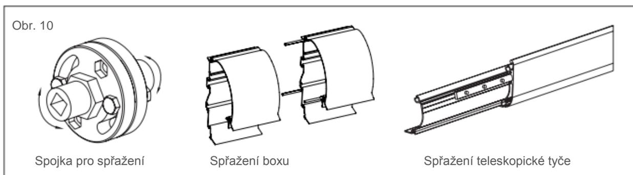
Pro spřažené markýzy typu DAKOTA existují dvě alternativy: kardanová spojka bez překrytí mezery nebo kardanová spojka s překrytím mezery. V obou případech má každá část svou látku.
