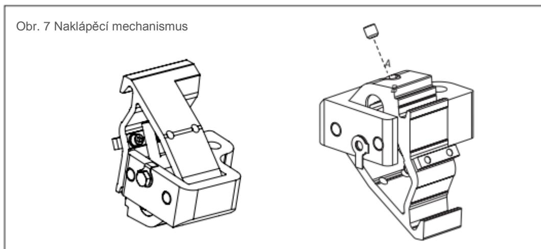
Pokud otáčíte seřizovacím šroubem doprava, výpadový profil se zvedá; pokud jím otáčíte doleva, profil klesá. Při otáčení podpírejte konce ramen. Šroub se otáčí snadněji, když není zatěžován celou vahou ramene. Toto platí zejména v případě zvedání ramen.
