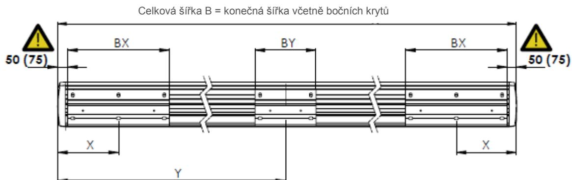
Obr. 3 Podrobný příklad pro umístění stěnových držáků
