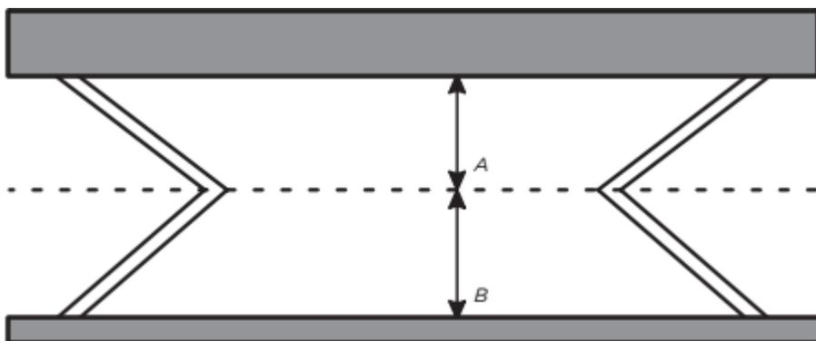
Správně: kloubové body jsou na stejné horizontále a vzdálenost A = vzdálenosti B.
