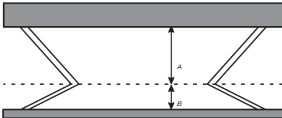
Nesprávně: není symetrické, vzdálenost A není úměrně rovná vzdálenosti B.
