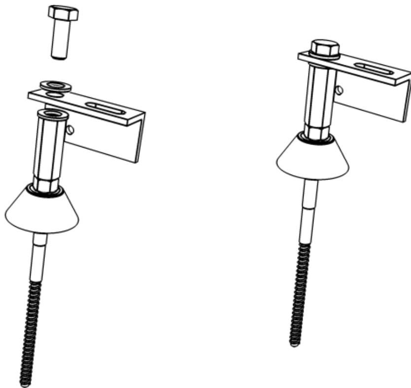
Montáž nosného profilu lu kombiskrutke vykonať podľa zobrazenia. Vratové skrutky M8x20mm nasunúť do profilu. Skrutky nasúvať z bočnej strany, popr. cez vyseknuté drážky v profile. Následne nasunúť nosný profil so skrutkami na uholník a pritiahnuť ho pomocou prírubových matíc.
