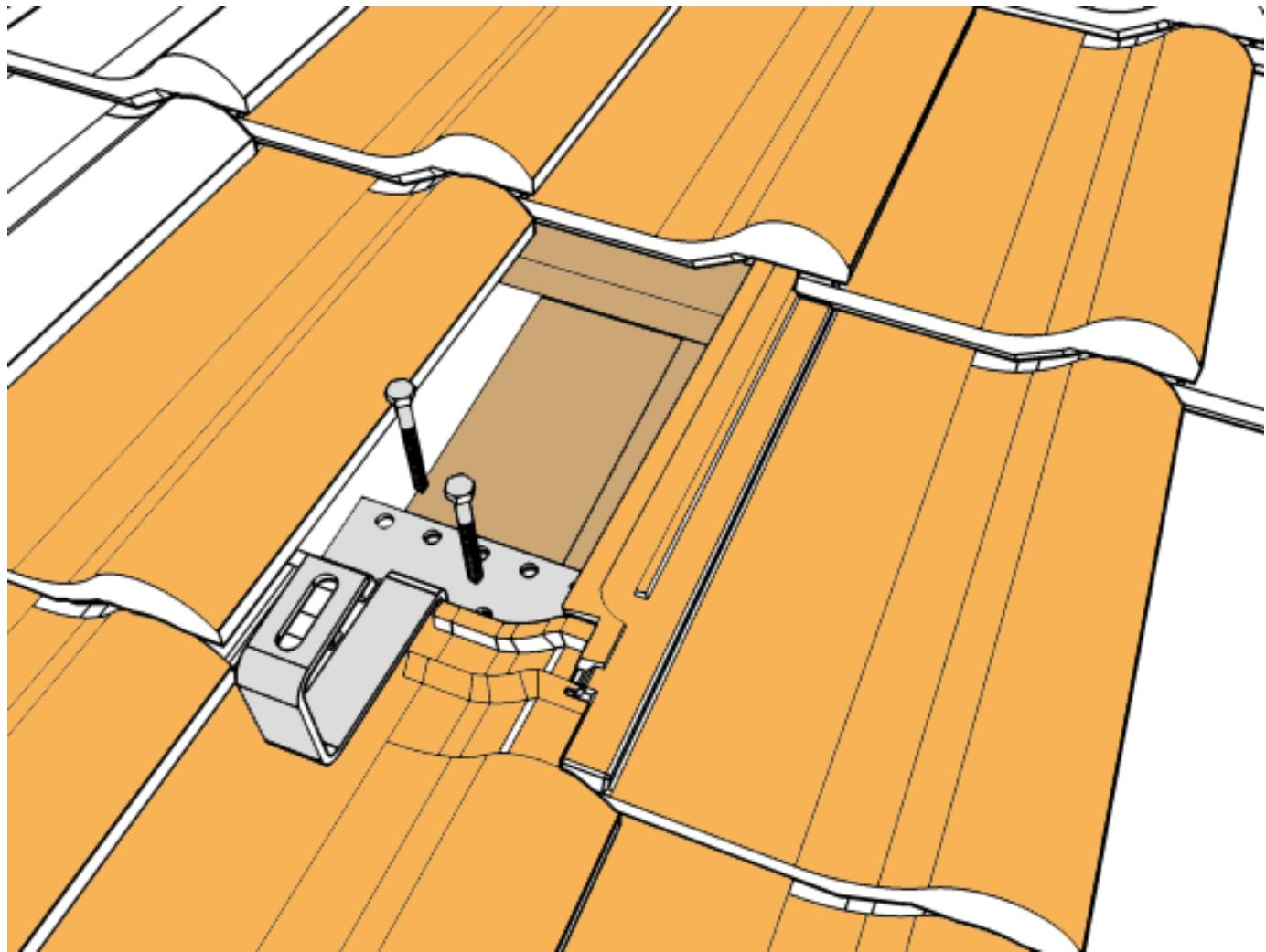
Pri montáži háku musí byť dodržaná pravidlo minimálnej medzery medzi hákom a škridlou. Je potrebné dodržať vzdialenosť 5 mm. Vid' obrázok.
