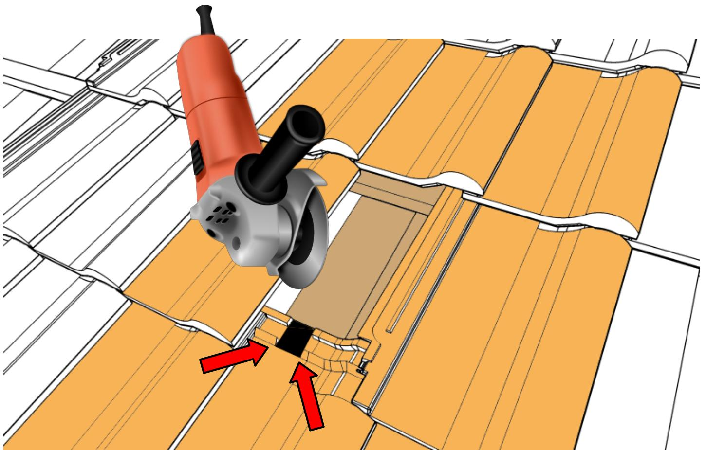
Správne uložený hák upevníť podľa zobrazenia vrutmi do dreva s min. dĺžkou 80 mm. Použiť vruty art.č.: F1486 (F1488). Pokiaľ dôjde k podloženiu háku je potrebné použiť vruty s min. dĺžkou 120 mm, art. č.: F1487 (F1489). Dieru predvŕtajte vrtákom ø5 na 2/3 celkovej dĺžky vrutu. Vruty pre montážou namažte tuhým mazivom.
