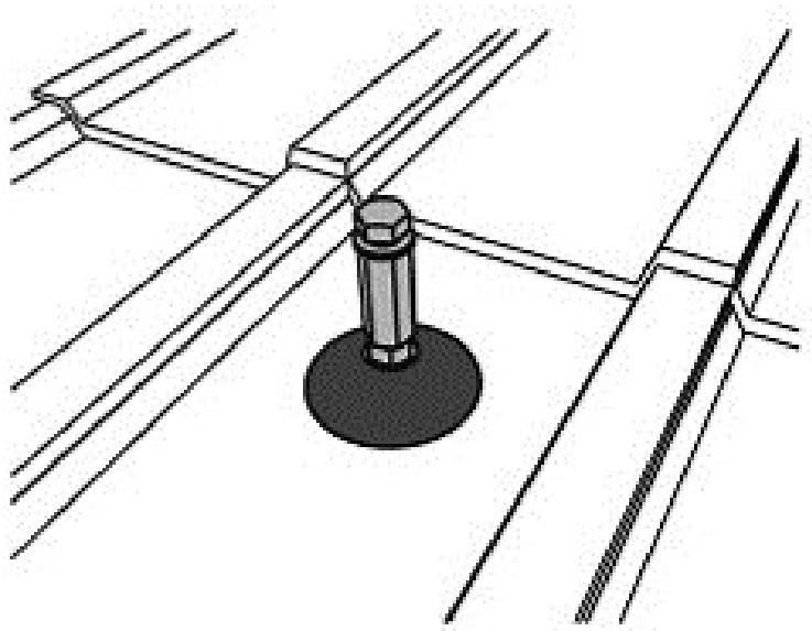
Montáž uholníka S3843 ku kombiskrutke, ktorý je potrebný pre upevnenie nosného profilu.
