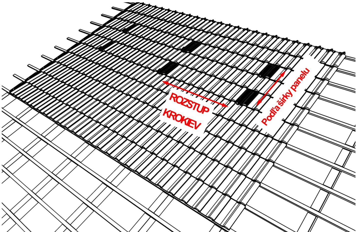
Na vyznačených miestach vyvŕtať otvory. Strešnú krytinu prevŕtať korunkovým vrtákom ø25mm nízkymi otáčkami, aby sa krytina nezlomila. Dávať pozor nato, aby bol dodržaný uhol 90° medzi krovou a vrtákom. Krovky navŕtať dlhým vrtákom na drevo ø8mm v strede už navŕtaných otvorov v krytine.
