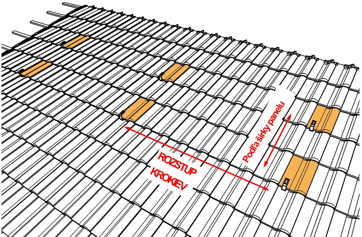
Po namontovaní hákov, pristúpte k montáži nosných profilov. Profily upevniť k hákom podľa zobrazenia. Použiť vratové skrutky M8x20 a prírubové matice M8. Skrutky nasúvať z bočnej strany profilu, popr. cez vyseknuté drážky.
