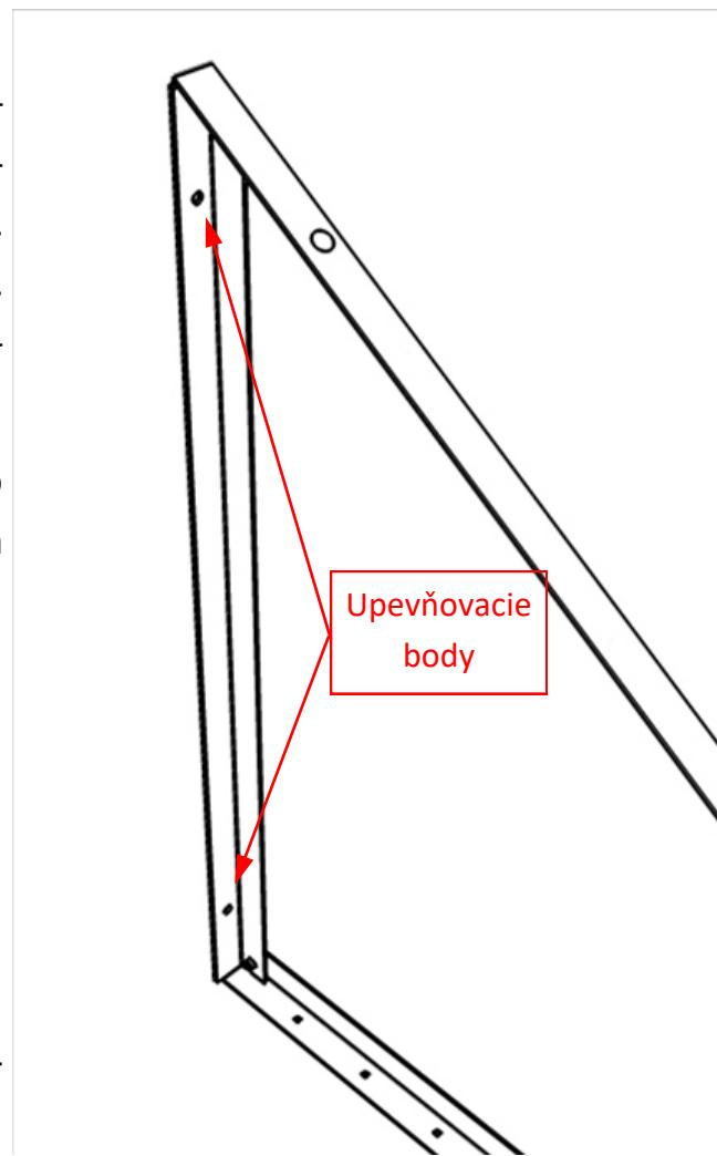
**Montáž konštrukcie so sklonom  $60^{\circ}$  (Ide o konštrukciu na rovnú strechu pootočenú o  $90^{\circ}$ )**
