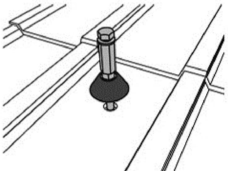
Kombiskrutku naskrutkovať do krovky, tak aby tesnenie dokonale priľnulo na krytinu a utesnilo dieru. Pri predpokladanej netesnosti, alebo drsnom povrchu krytiny je nutné podtmeliť tesnenie kombiskrutky silikónovým tmelom.
