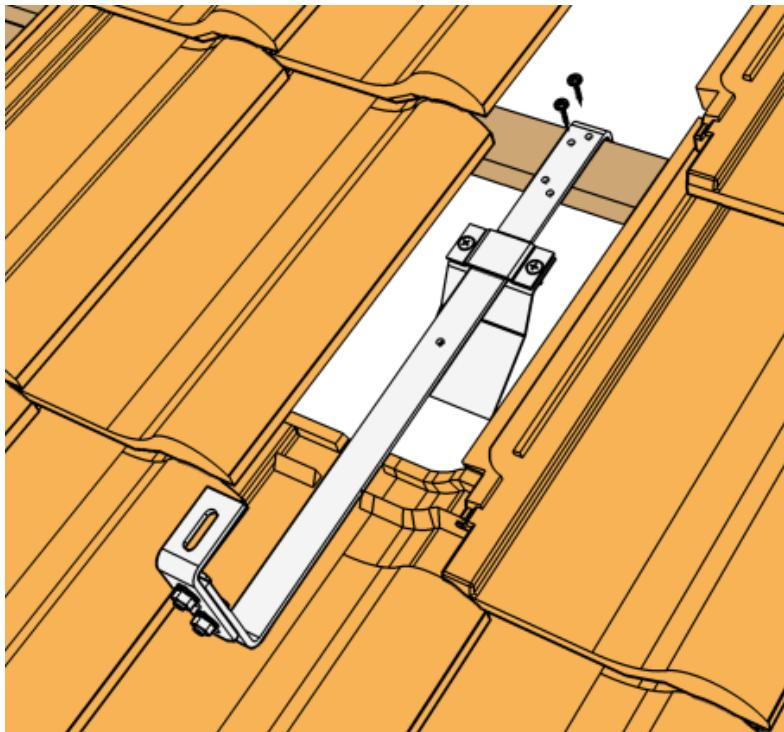
Strešný hák zavesiť a dvomi skrutkami do dreva ( $\varnothing 5 \times 30$  - F1406) poistiť. Upevňovacie šmýkadlo posunúť pod spodnú škridlovú latu a pevne skrutkami zoskrutkovať. Upevňovacie šmýkadlo zabraňuje zdvihnutiu háku. Pri veľmi hrubých škridlách šmýkadlo ohnúť tak, aby zasahovalo pod škridlovú latu, nielen pod škridlu. **Podľadruhustrešnej krytiny samuší škridlav mieste uloženia háku upraviť tak, aby hák ležal celou plochou na škridle!**
